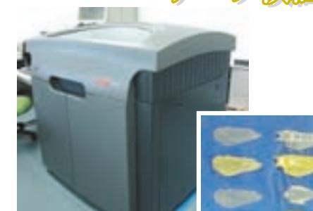
光造型機「エデン」は設計データを元に、光をあてると硬化する樹脂を使って試作品を作り出すスグレモノ！ こうして設計されたモデルのデータは、金型ルームのCAMシステムに送られる。
