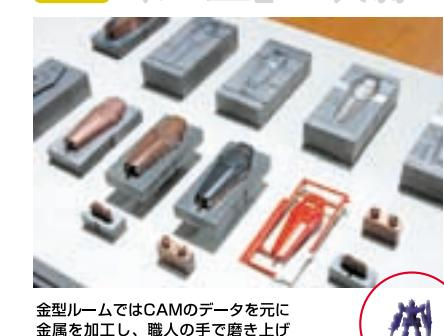
金型ルームではCAMのデータを元に金属を加工し、職人の手で磨き上げて「金型」を作る。近年はレーザー加工機を導入し、40ミクロンという微細な加工も可能になった。
