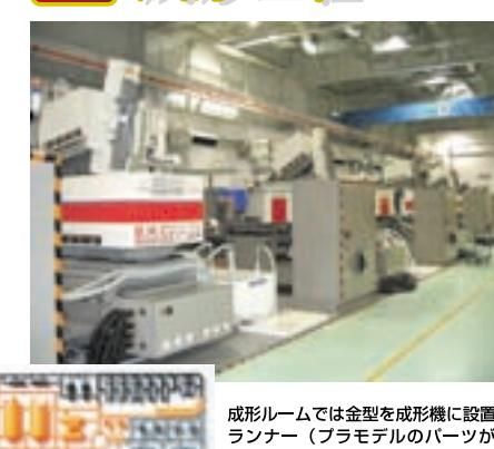
成形ルームでは金型を成形機に設置し、ランナー（プラモデルのパーツがつながった物）を次々に生産。一つのランナーに複数の色を成形した「いろプラ」はバンダイだけの技術だ。
